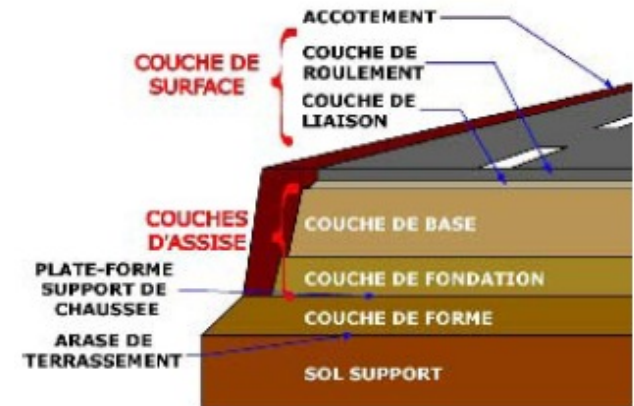
Coupe d'une chaussée. (Source: thèse de [T-B. Nguyen, 2008])
