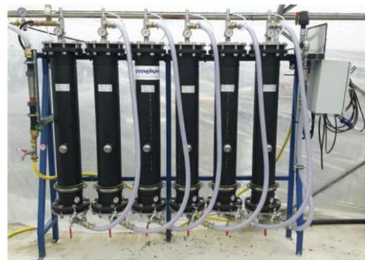
**Pilotes de traitement des eaux souterraines par filtration**
