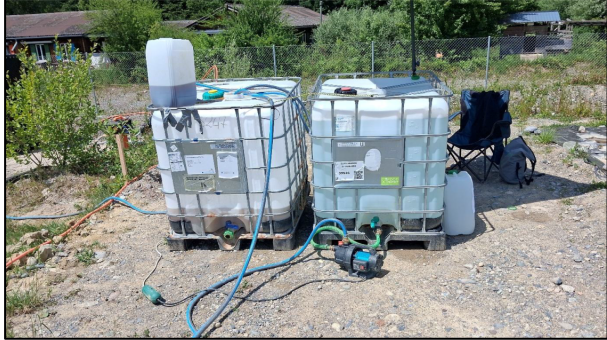
Fig. 1a : Dispositifs de lavage in-situ sur un site à pollution AFFF (réalisé par HPC & Sensatec).
