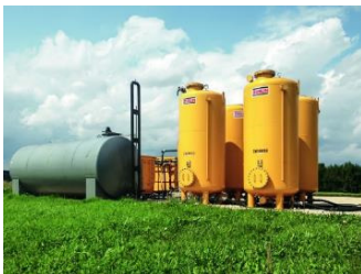
Installation mobile, eau de chantier (Bavière), 10 m³/h
