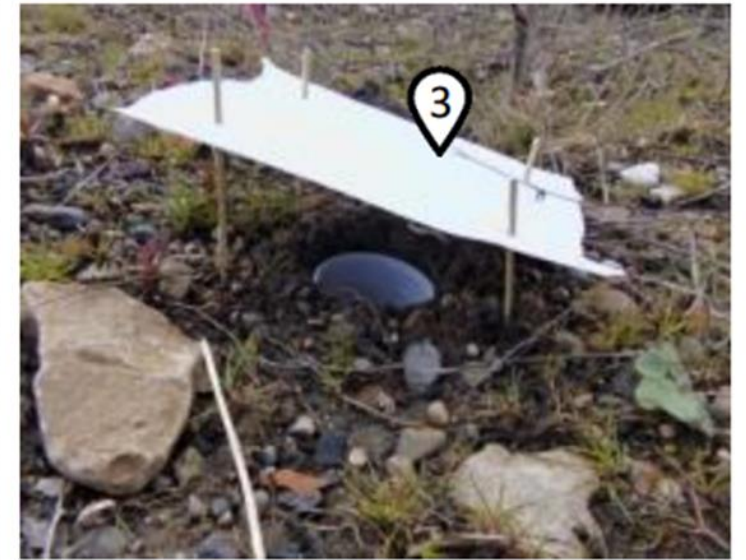
Figure 2.14 : Photographie d'un dispositif d'échantillonnage de la macrofaune épigée par pot piège. [1]: pot en plastique ; [2]: solution d'éthylène-glycol, [3]: toit de protection.
