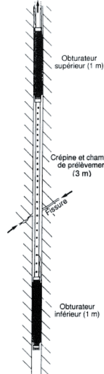
OBTURATEUR DOUBLE EN P.V.C. EN PLACE (Longueur : 5,6 m)
