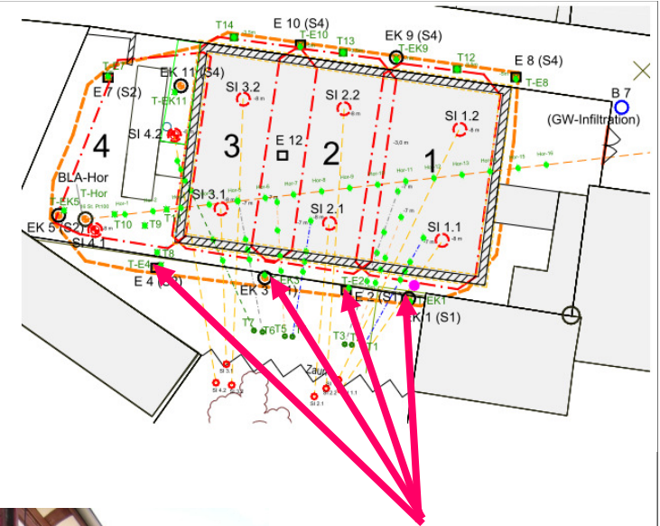
Mise en place des forages verticaux
