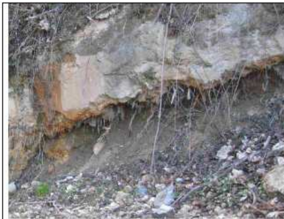
Laitier cristallisé reposant sur remblai terreux
