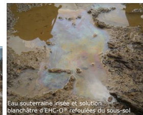
Eau souterraine irisée et solution blanchâtre d'EHC-O® refoulées du sous-sol
