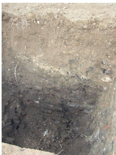
Différentes couches de remblais identifiables par les indices organoleptiques
