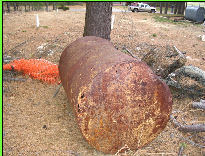
Un réservoir d'huile de chauffage pour une résidence près d'Atlantic City. Cette réservoir avait un âge de moins de dix ans.
