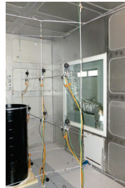
Vue intérieure de la chambre EMMA équipée de sondes de température, CO 2 et d'anémomètres de précision.
