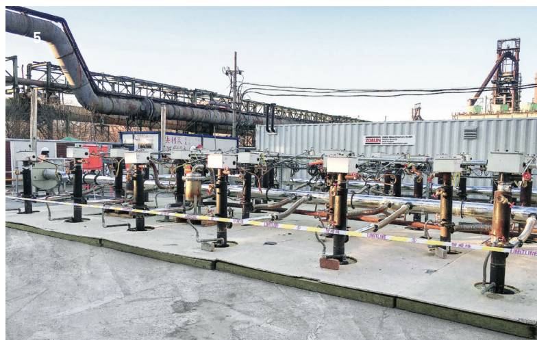
3 ISTH, corps de chauffe électriques, Suisse © SBB CFF FFS/ 4 ISTH, injection d'air / de vapeur, Allemagne de Nord/ 5 ISTH, corps de chauffe au gaz, Chine
