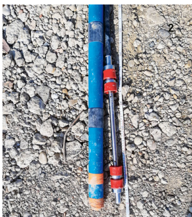
1 Barrière hydraulique, Allemagne du Sud / 2 Tube à manchon / packer / 3 Schéma fonctionnel ISCO, © Züblin Umwelttechnik GmbH
