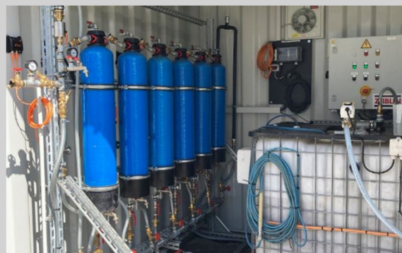
Fig. 5: Installation d'essai mobile avec six cartouches filtrantes pour tester différents médias filtrants, Qw = 150 - 300 l/h
