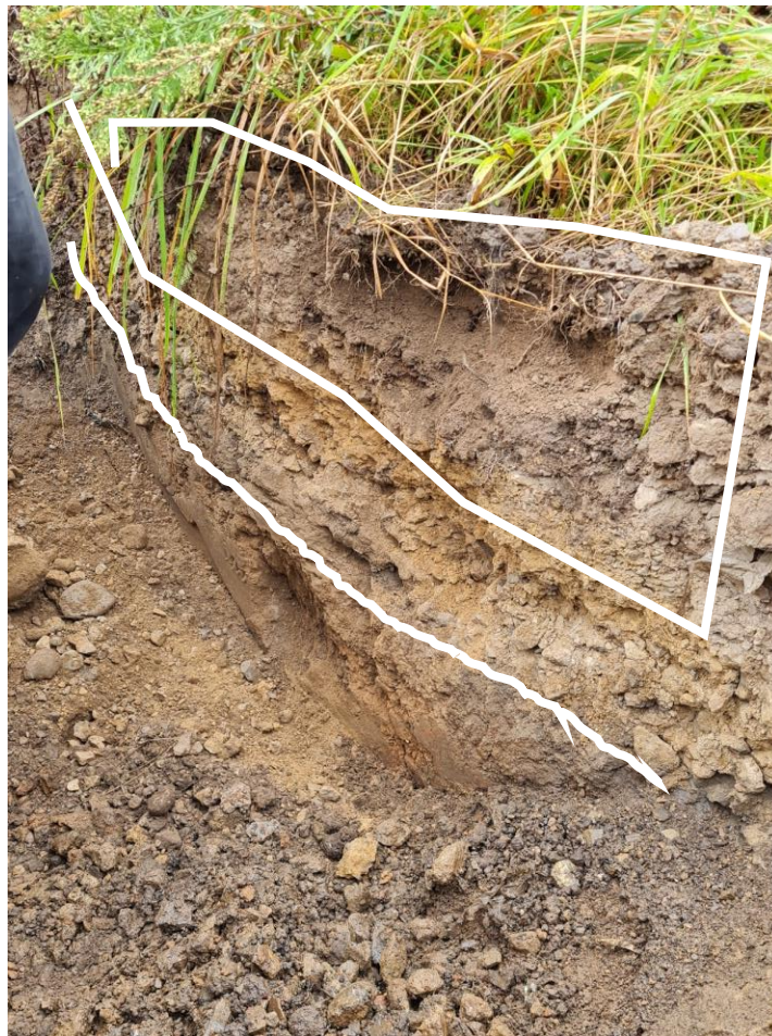
Remblais sur sol en place
