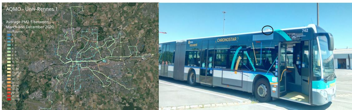
Figure 1 : (gauche) valeurs agrégées de mesure des PM2.5 sur la métropole rennaise (environ 1.2M de mesures ont été faites en 2020 (droite) bus équipé d'un micro-capteur AlphaSense OPC-N3.
