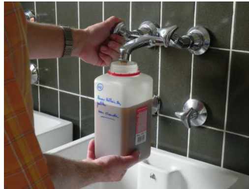
Présence de rouille dans la tuyauterie
