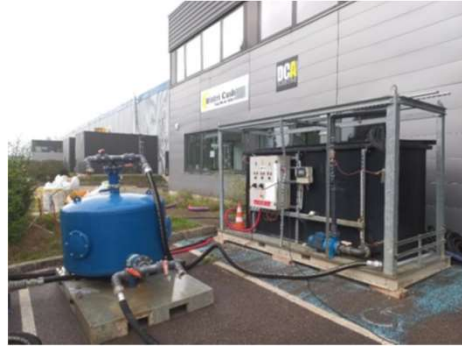
Séparateur HC et filtre à sable
