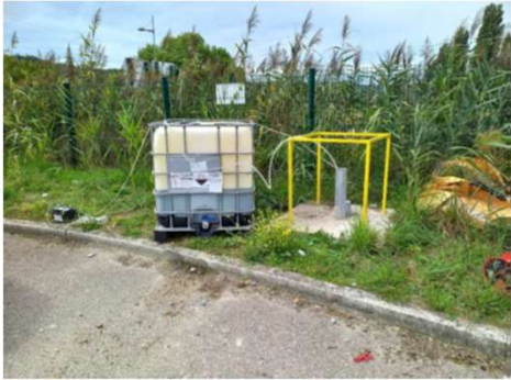
Pompage dans piézomètre existant
